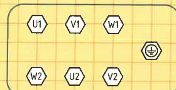
Motor-Netzanschluss für Linkslauf (Beispiel)
