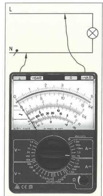
Bild 3: Messen an einer Leuchte
