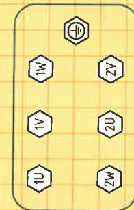
Motor-Netzanschluss für Linkslauf (Beispiel)
