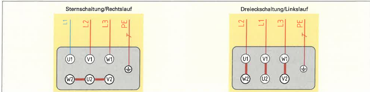
Bild 1: Klemmbretter von Drehstrommotoren mit Kurzschlussläufer
