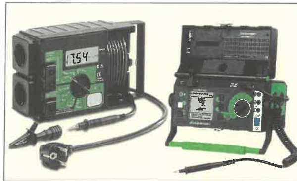
Bild 1: Messgeräte (Beispiele) zur Prüfung nach DIN VDE 0701-0702
