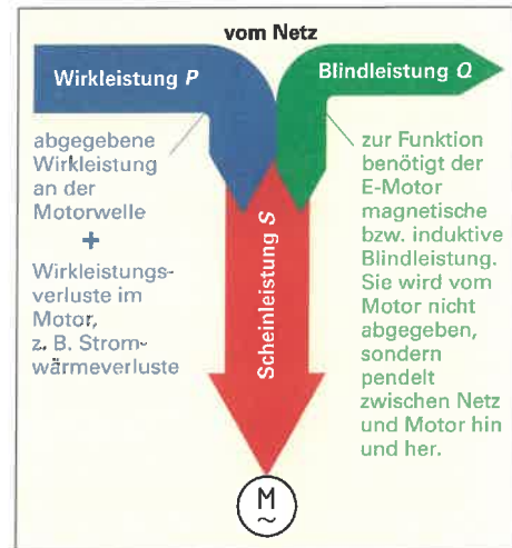
Bild 1: Wechselstromleistungen am Beispiel eines AC-Motors
