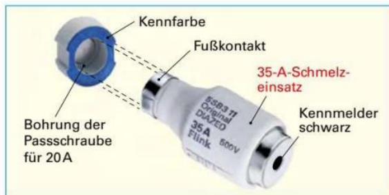
Bild 3: Unverwechselbarkeit der Schmelzeinsätze
