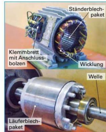
Bild 1: Aufbau eines Drehstrommotors
