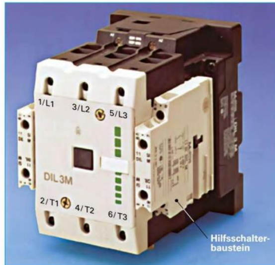
Bild 1: Leistungsschütz mit drei Hauptstromkontakten und angebauten Hilfsschalterbausteinen
