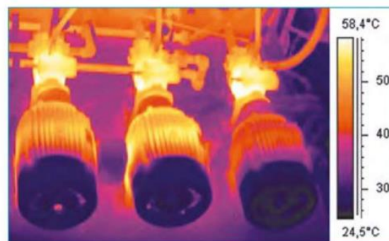
Bild 3: Infrarot-Thermografie zeigt auffälligen Elektromotor (Bildmitte)
