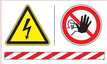
Warnschild bei Spannungen über 1 kV
