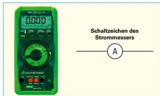
Bild 3: Vielfachinstrument, als Strommesser eingestellt
