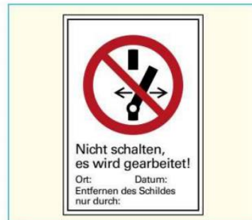
Bild 3: Verbotsschild für Arbeiten an freigeschalteten Anlagen
