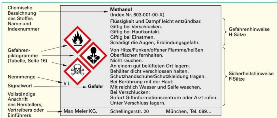
Bild 1: Beispiel für die Kennzeichnung eines gefährlichen Stoffes
