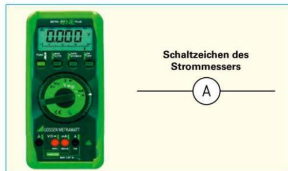
Bild 3: Vielfachinstrument, als Strommesser eingestellt
