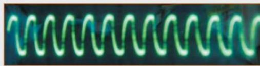
Bild 2: Ausgangsspannung eines elektronischen Transformators (Frequenz f = 38 \text{ kHz} )
