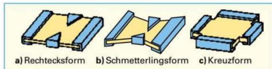
Bild 3: Bauformen von Hallgeneratoren
