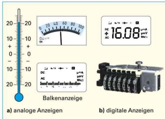
Bild 1: Analoge und digitale Anzeigen
