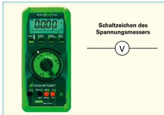
Bild 1: Vielfachmessinstrument, in der Einstellung Gleichspannungsmessung
